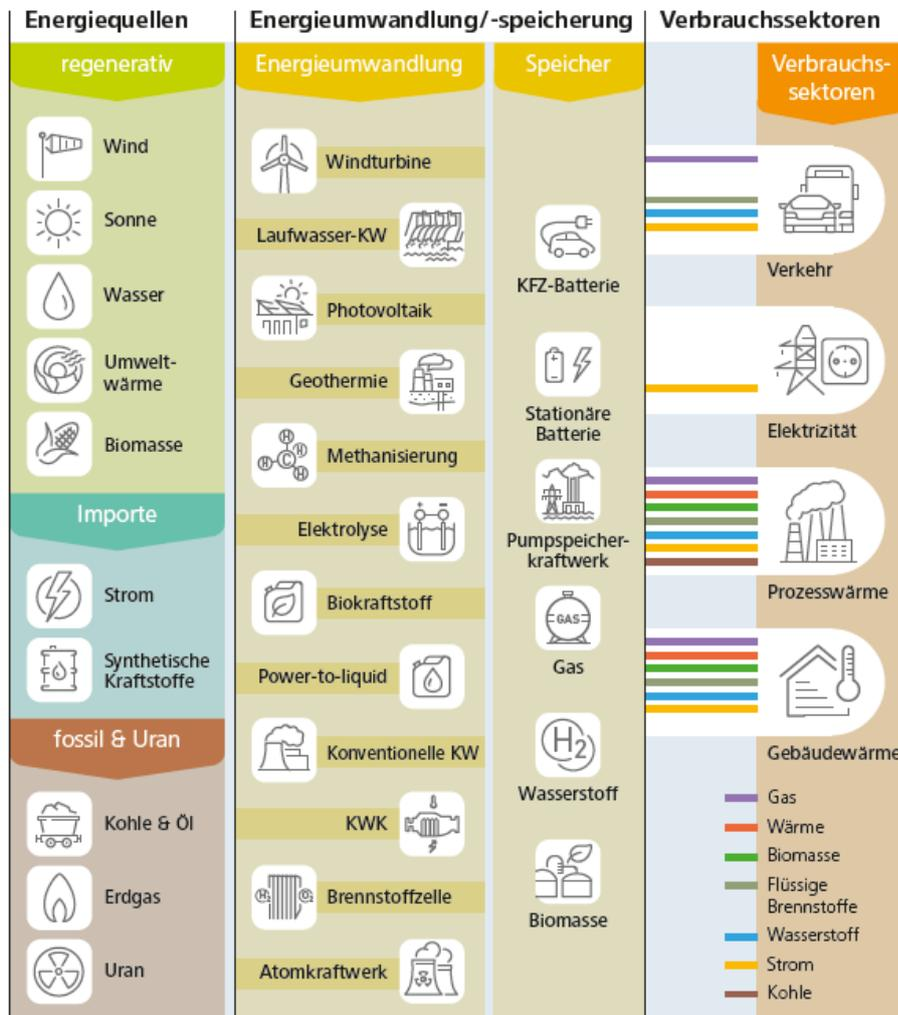
**Abbildung 45: Schematische Darstellung des Modells REMod (KW: Kraftwerk, KWK: Kraft-Wärme-Kopplung, [ISE12])**
