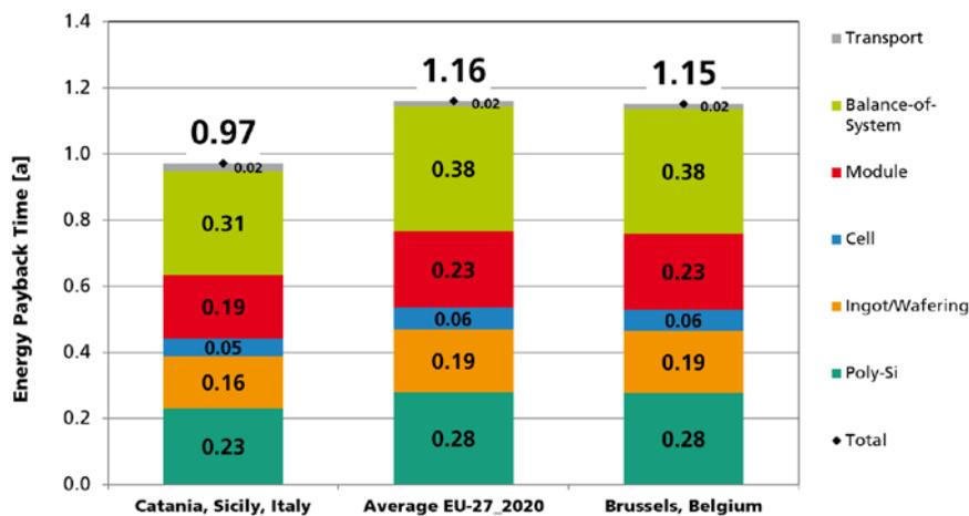
Abbildung 28: Berechnete Energierücklaufzeiten von PV-Kraftwerken für europäische Produktions- und Betriebsstandorte [ISE10], Daten: Lorenz Friedrich
